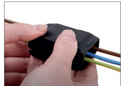
Easy-Protect-Gelbox zusammendrücken; das Gel umschließt die Verbinder und der Deckel rastet ein
